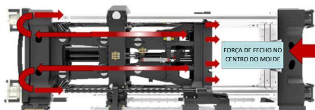
O sistema “Centre clamping” da Bole EKS aumenta em 30% a rigidez geral da estrutura dos equipamentos e a eficiência no fecho molde.
